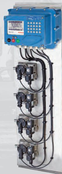
Modules d'injection d'additifs commandés par le calculateur de débit
