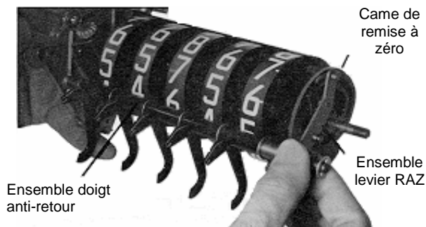
Figure 17. Montage ensemble doigt anti-retour
