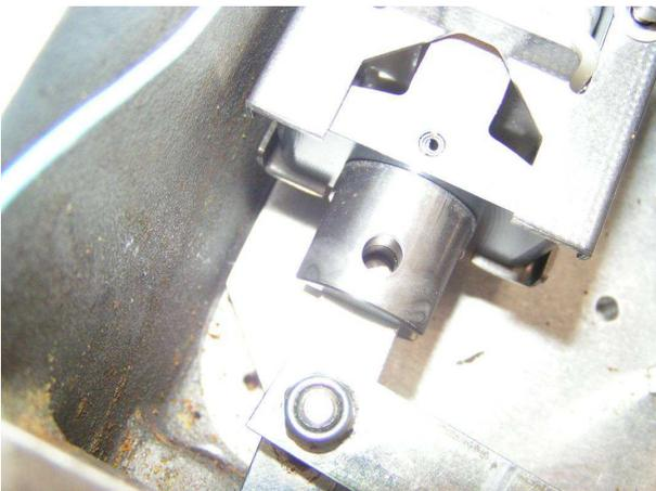
12. Soulever l'axe afin de remonter l'écrou
