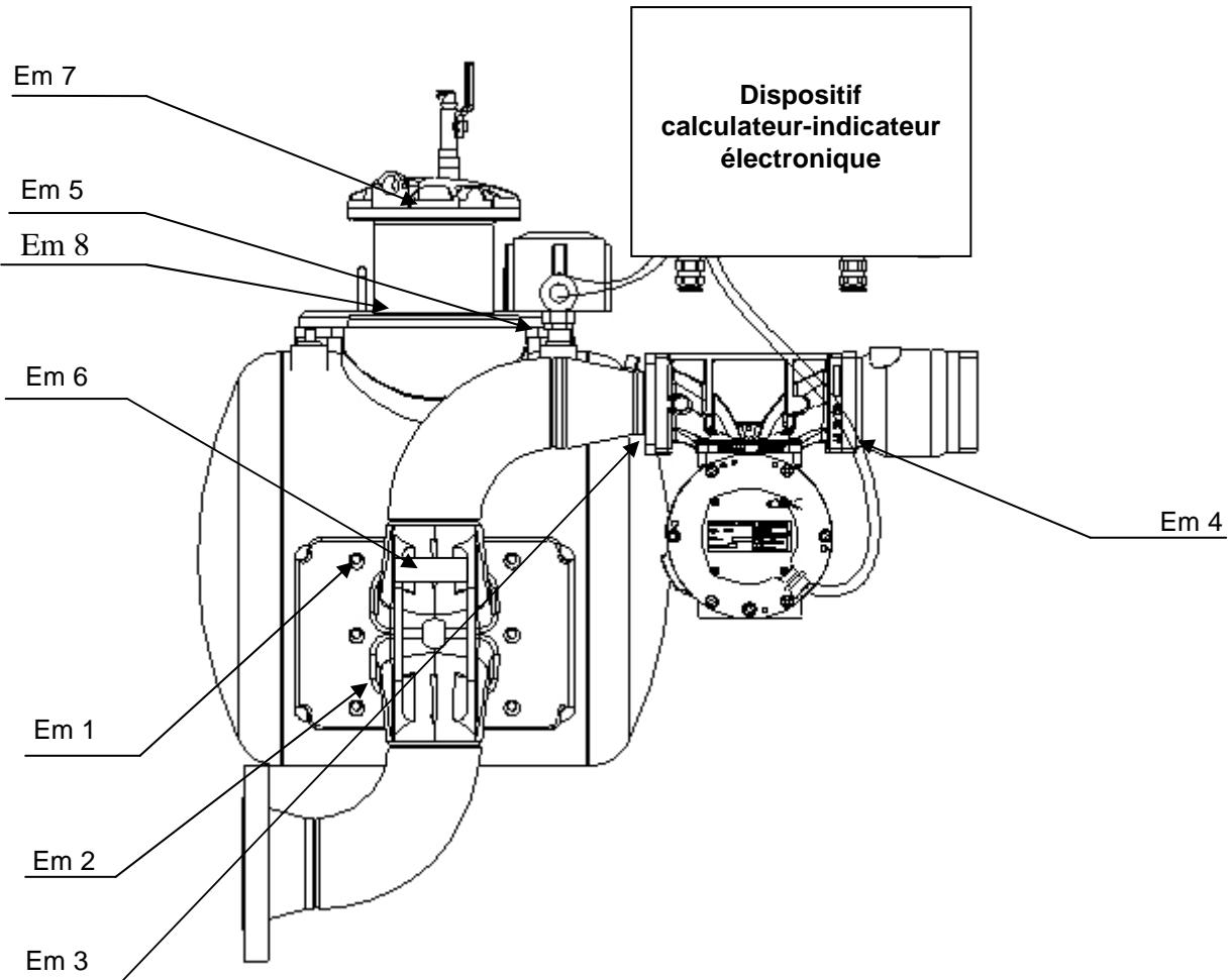
Em 1 : Interdit le démontage du filtre purgeur de gaz
