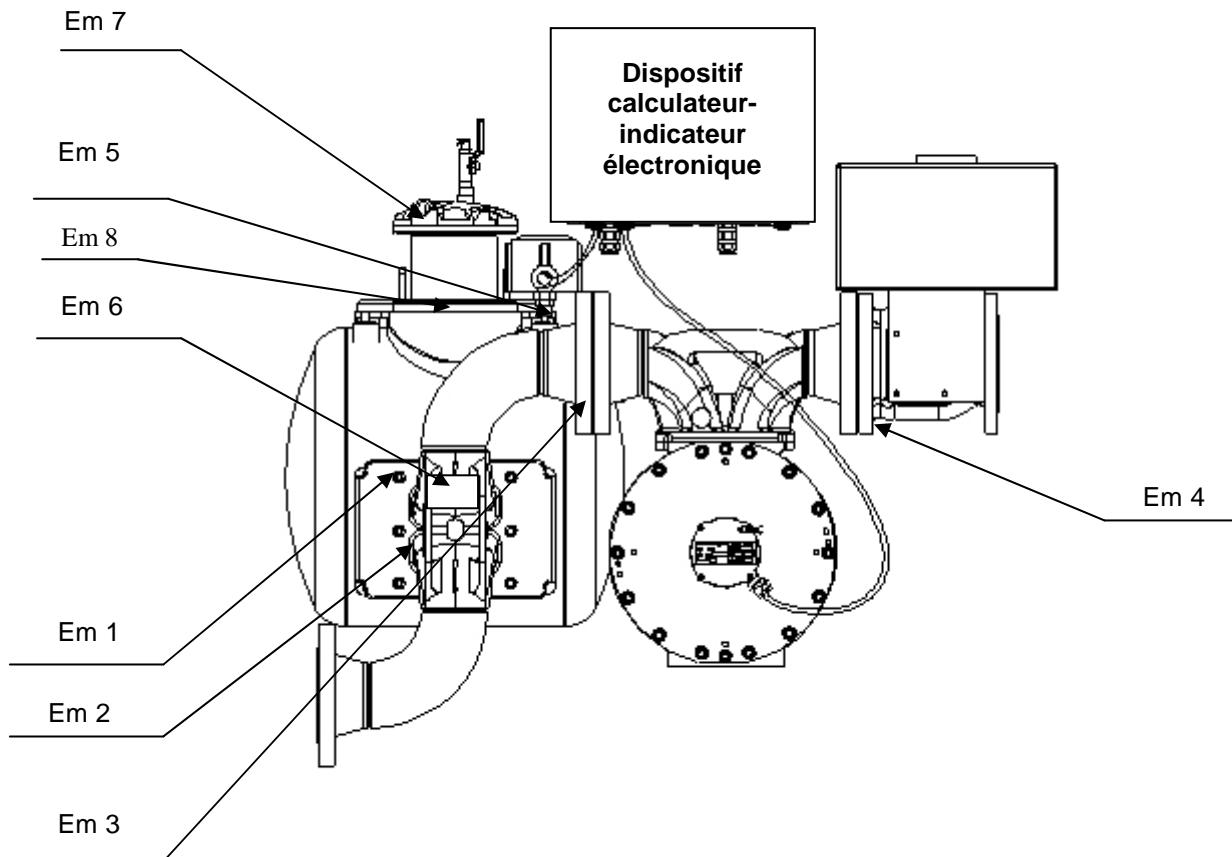
Em 1 : Interdit le démontage du filtre purgeur de gaz
