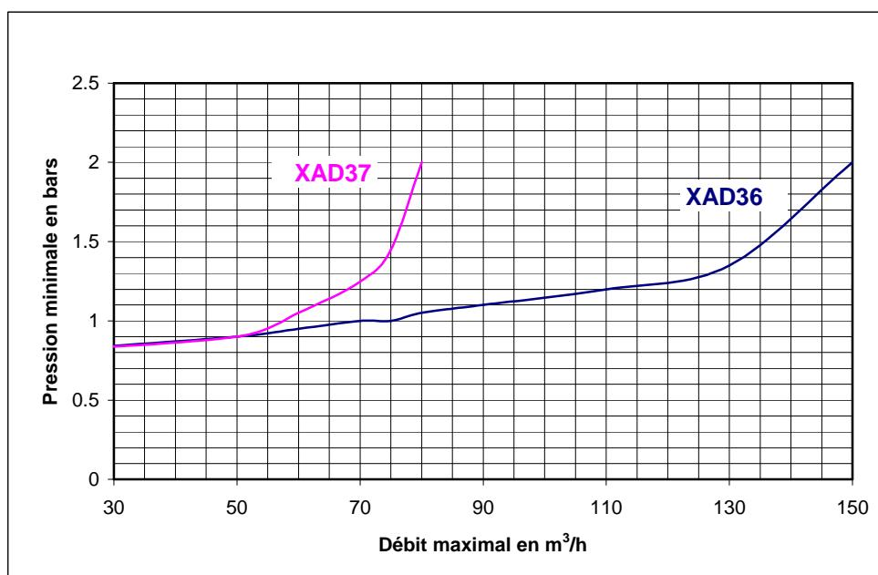
Dans ce cas, le débit maximal et la pression minimale devront être renseignés sur la plaque d'identification de l'ensemble de mesurage sur la base du débit maximal atteint lors des essais d'exactitude de la vérification de conformité sur site (voir §§ 8 « Conditions particulières de vérification »).
