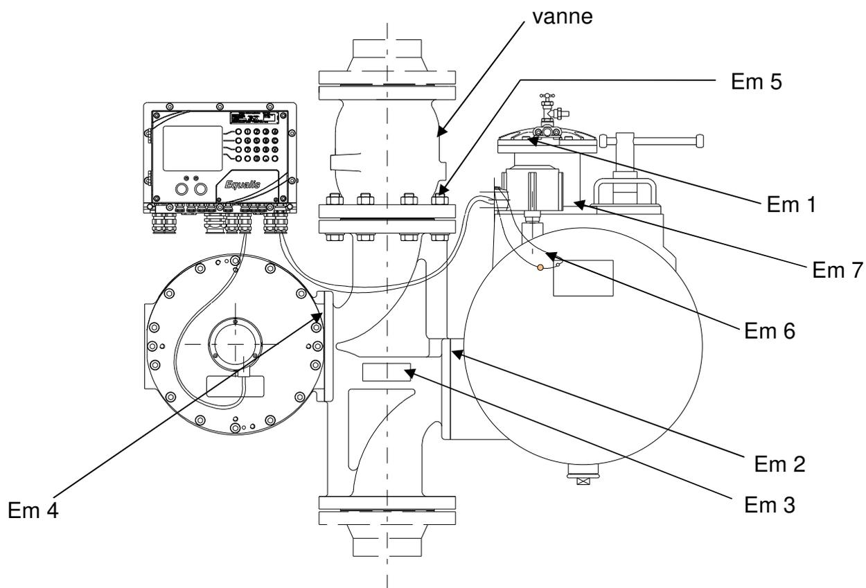
Em 1 et 7 : Interdit le démontage de la tête de dégazage
