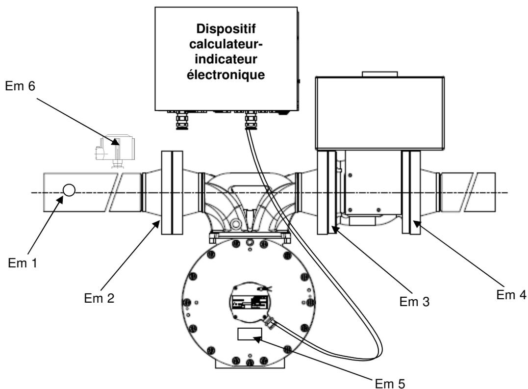
Le compteur, le dispositif de détection automatique de gaz et de purge et la vanne automatique d'arrêt peuvent être montés en position horizontale ou verticale.
