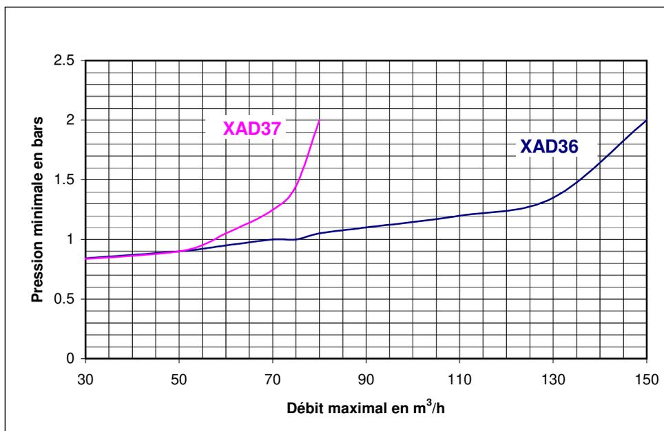
Dans ce cas, le débit maximal et la pression minimale devront être renseignés sur la plaque d'identification de l'ensemble de mesure sur la base du débit maximal atteint lors des essais d'exactitude de la vérification de conformité sur site (voir § 8 « Conditions particulières de vérification »).
